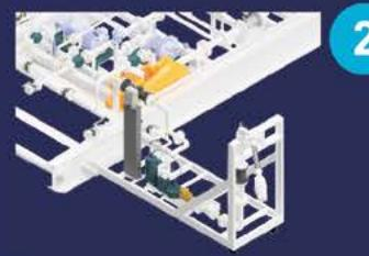
Módulo para carga de Autotanque con bomba y medidor.
