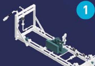
Módulo para descarga de Semirremolques con compresor.
